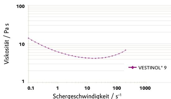
Messgerät: Rheometer, Einspaltzylinder CC 27
