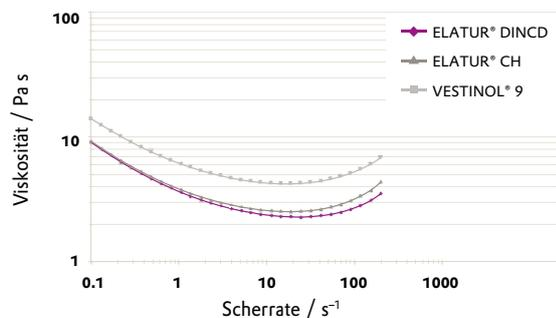
Messgerät: Rheometer, Einspaltzylinder CC 27
