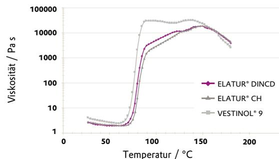
Messgerät: Rheometer, Platte/Platte PP 25
