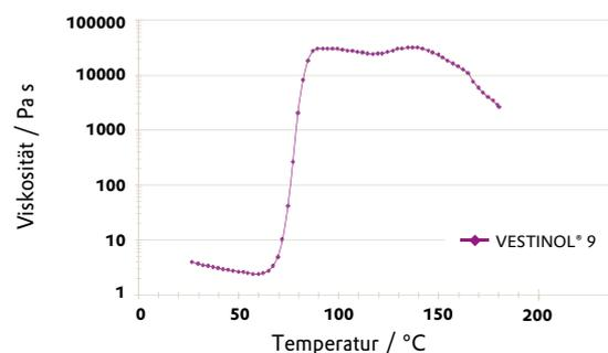
Messgerät: Rheometer, Platte/Platte PP 25
